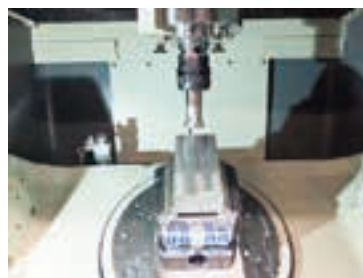
●5軸加工：ワンチャック加工 段取1回⇒時間短・精度向上
