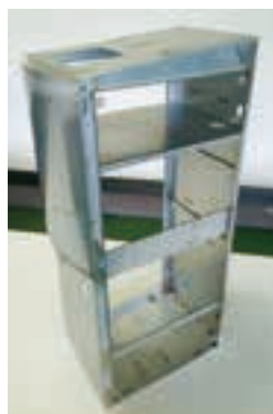
□製品名：装置カバー ●使用材料：SUS304 2B t1.5/t2.0 ☆溶接仕上げ（後処理：塗装） ○製品サイズ：W255×D320×H730
