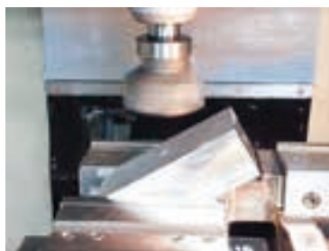
●3軸加工：バイスを使用 複数回の段取り必要⇒時間長・精度低下
