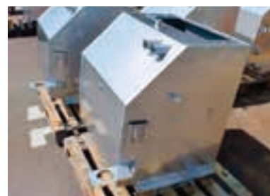
□製品名：タンク ●使用材料：SUS304 2B t2.0 ☆溶接焼け取り+水漏れ検査 ○製品サイズ：W770×D700×H1000
