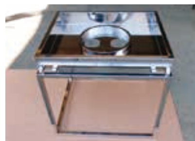
□製品名：ステンレス作業台 ●使用材料：SUS304 #400 ☆溶接焼け取り+パフ仕上げ
